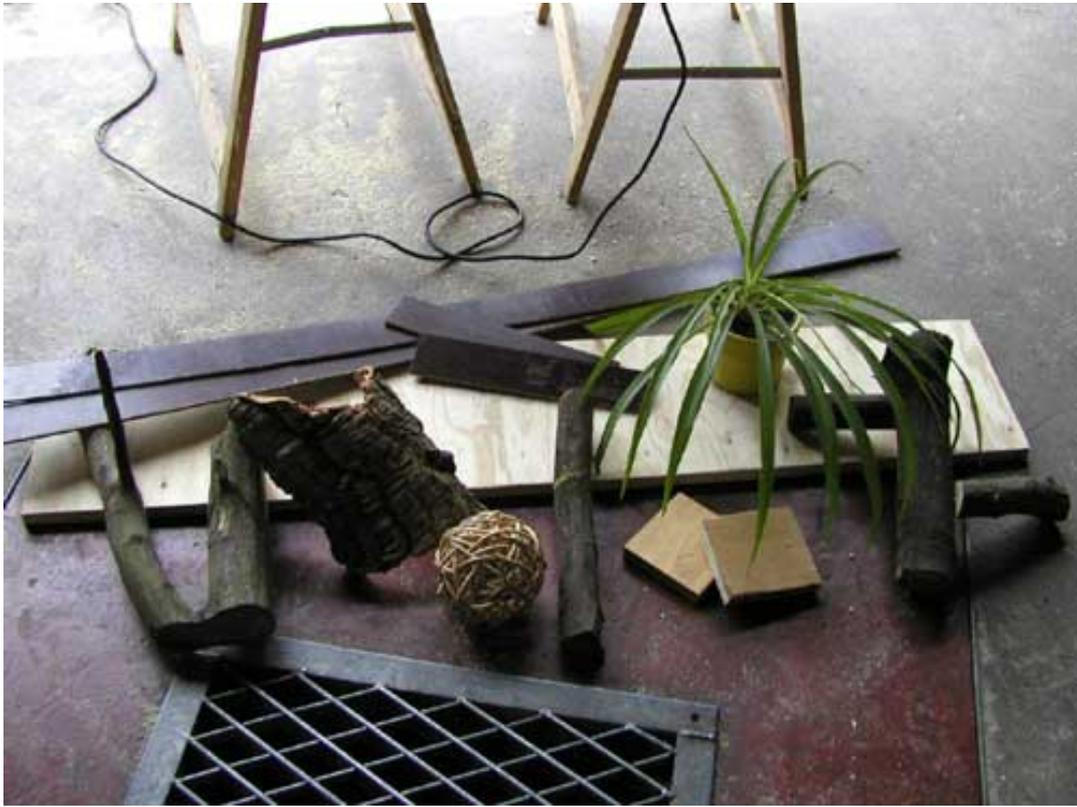
Zunächst muss die Grundplatte entsprechend der Fensterbankgröße zurechtgeschnitten werden. Anschließend sollten die dünnen Platten entsprechend der Größe der Grundplattenkanten hergestellt werden. Die Umrandungsplatten sollten ab Grundplattenoberkante etwa 4 cm hoch sein, damit der Boden später mit Buchenholzgranulat oder Hugro gefüllt werden kann. Die Umrandungsplatten bitte noch nicht anschrauben, da sie die Montage der Holzpfosten erheblich behindert.
