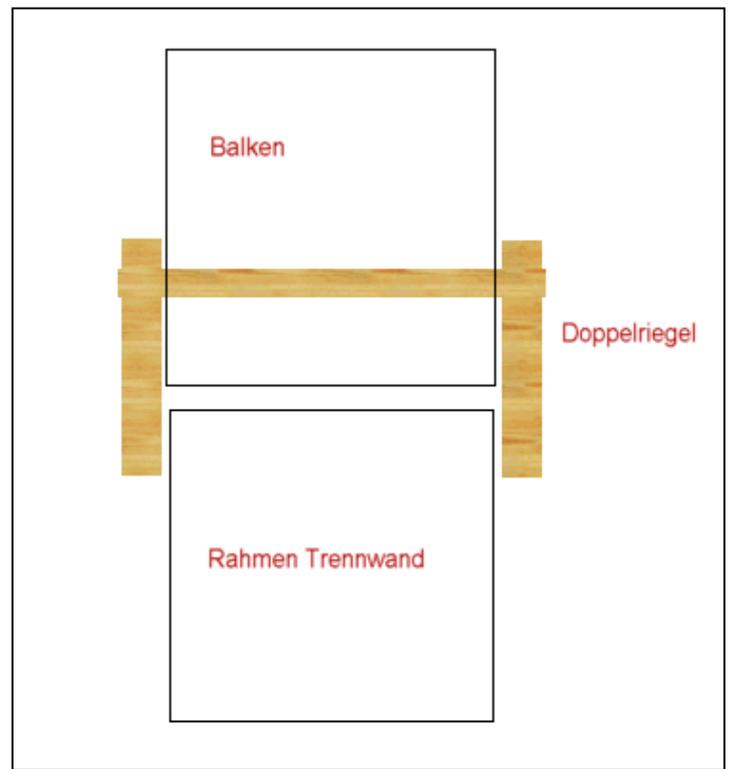
Für die Befestigung einer Trennwand muß an der Rückwand ein Vierkantholz und hinter dem Türbalken eine Latte angeschraubt werden, damit Platz zur Befestigung von beidseitigen Riegeln entsteht. Bei der vorderen Latte ist zu beachten, daß diese für die Riegel der großen Türen unterbrochen werden muß.
