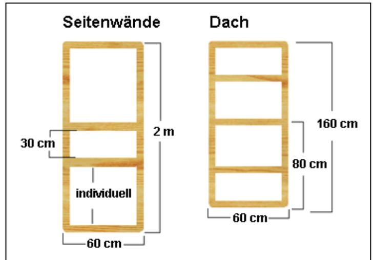
Nun werden zuerst die Seitenwände (1) mit langen Schrauben von unten an die Bodenplatte (3) montiert. Danach wird das Dach (2) mit Winkeln an die Seitenwände geschraubt. Danach können die Seitenplatten (4) montiert werden.
