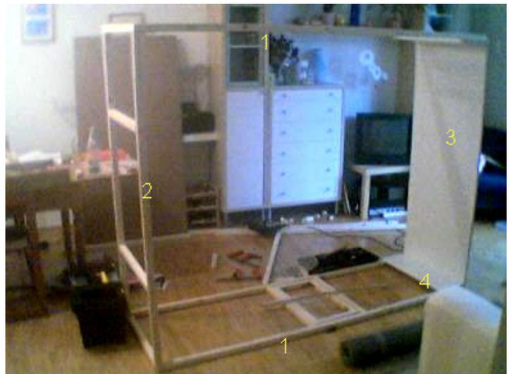
Für das Drehfenster wird ein Rahmen gebaut, der etwa 0.5 - 1 cm niedriger und wenige mm schmaler ist, als die Öffnung, in die es eingepaßt werden soll. Als Abstandhalter unten eignen sich Holzscheiben von ca.5 mm Dicke. Damit sich die Türe ganz drehen kann, ist es wichtig genau in der Mitte zu bohren. Als "Achse" wurde hier ein Rundholz von 10 mm Ø verwendet. Das heißt, daß ein 10 mm Loch gebohrt wird.
